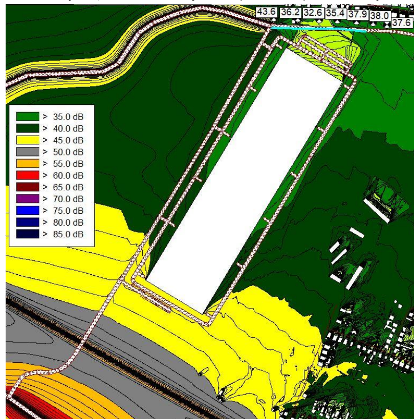
Obrázok 23 Simulácia cestnej dopravy – plošná hluková záťaž vypočítaná vo výške 1,5 m nad terénom a vypočítané hodnoty L_{Aeq} na hraniciach najbližších pozemkov, pre referenčný časový interval NOC
